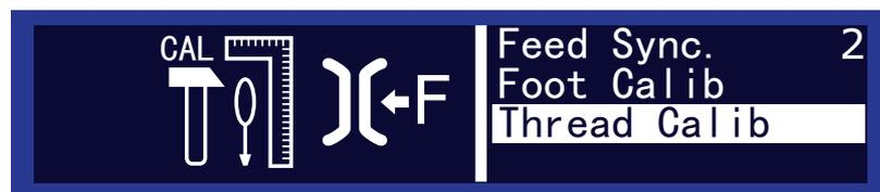
In diesem Unterpunkt kalibrieren Sie die Nadelfaden-Spannung. Zum Kalibrieren brauchen Sie ein Fadenspannungsmessgerät.
