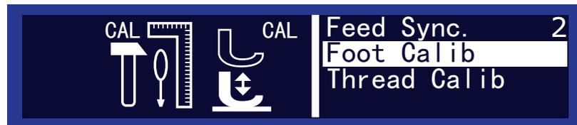
Die Steuerung muss die obere und untere Position der Nähfüße kennen. Die obere und die untere Position der Nähfüße werden durch die Kalibrierung in diesem Unterpunkt bestimmt.
