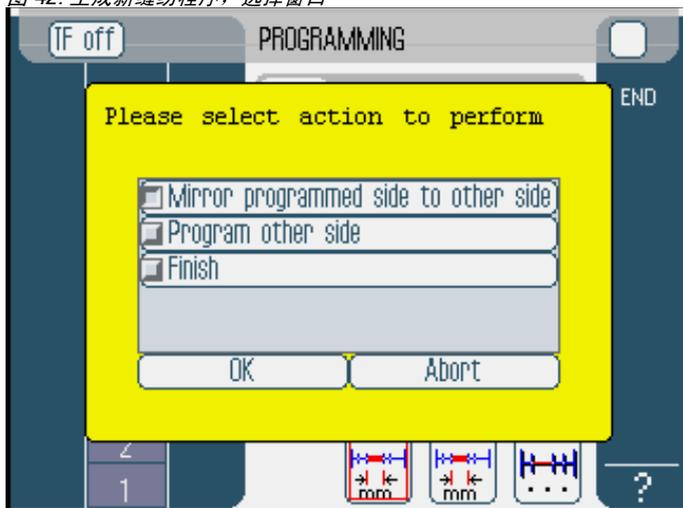
11. 选择是为另一边的镜像缝料（*另一边的镜像程序设定*）、进行其他新的缝纫程序设定（*另一边的程序*），还是结束程序设定（*结束*）。
