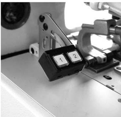
Mit dem Handtaster können die Klammern gesteuert und der Nähvorgang gestartet werden. Je nach Einstellung im Servicemenü (siehe Serviceanleitung) ist die Funktion unterschiedlich.
