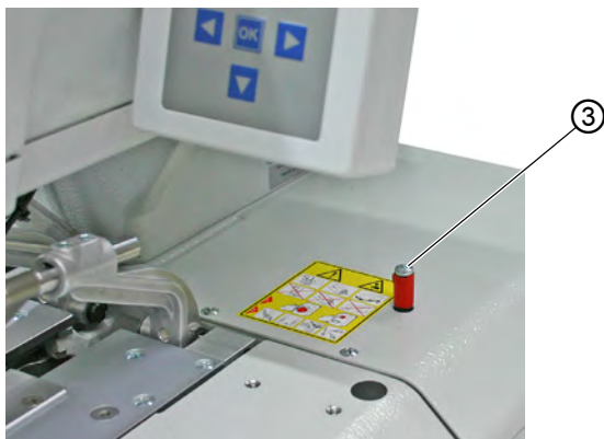
图 94：移除机器台板运输保护装置
