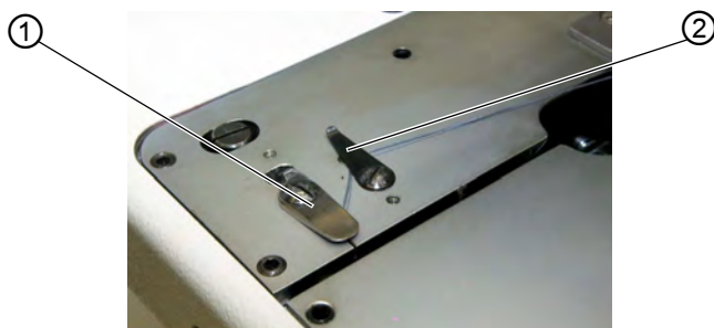
图 39：在分机型 151 上取出缝料
