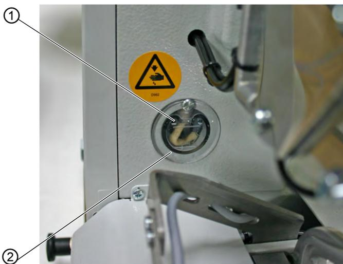
(1) - Abertura de enchimento      (2) - Depósito para lubrificação
