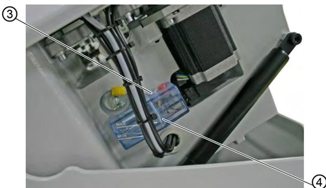
(3) - Abertura de enchimento      (4) - Depósito para lubrificação
