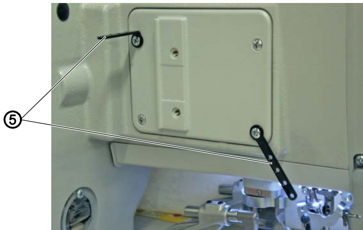
Abb. 11: Fingerschutz und Fadenführungen montieren (3)
