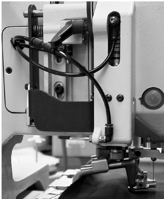
Ad esclusione della sottoclasse 579-151000 tutte le altre sottoclassi sono dotate di serie con un dispositivo intercettatore del filo dell'ago. La sottoclasse 579-151000, se desiderato, può essere equipaggiata a posteriori con un dispositivo intercettatore del filo dell'ago.
