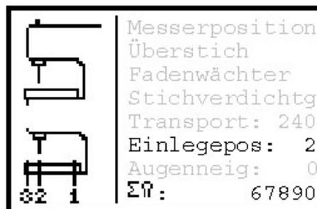
Con esto se puede determinar la posición de posicionamiento del material. Se pueden ajustar los siguientes valores:
