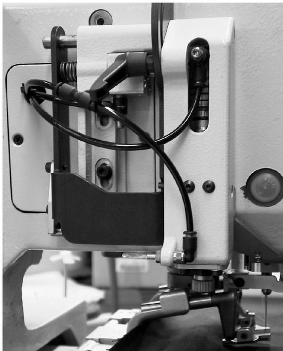
Aparte de la clase 579-151000 todas las subclases están equipadas en serie con un interceptador del hilo superior. La subclase 579-151000 puede ser reequipada, si se desea, con un interceptador del hilo superior. La función del interceptador del hilo se desconecta automáticamente con ojales con longitudes de más de 38 mm.
