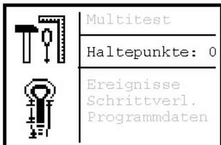
Con ayuda del programa de prueba “Puntos de parada” se puede controlar el orden de conmutación de las válvulas y la posición de las diferentes piezas después de la conexión o desconexión. Este programa de prueba es de ayuda en particular para ajustar el receptor de hilo y los sistemas de corte de hilo, porque se puede controlar la posición de las diferentes piezas respecto al hilo superior, al hilo inferior y al agremán.
