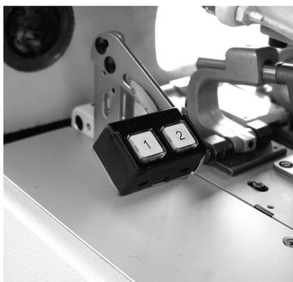
Tramite entrambi i tasti manuali possono essere comandate le pinze e può essere avviato il ciclo di cucitura. Il funzionamento è differente a seconda della regolazione che è stata effettuata nel menù di servizio (consultare le istruzioni per il servizio).
