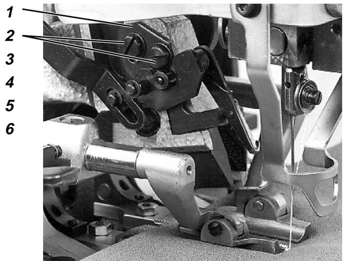
Le capteur du fil supérieur s'abaisse et se soulève avec le mouvement de la barre de coupe 3.
