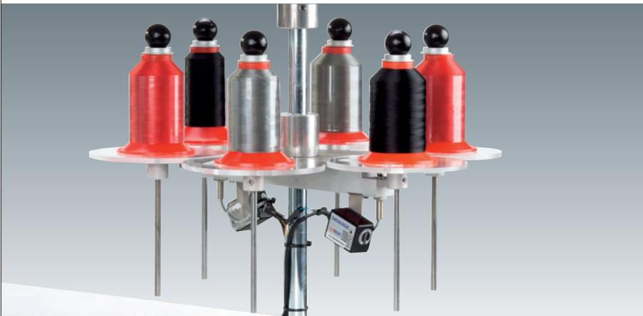
Scanner für Endlabel-Erfassung des fertig genähten Teiles mit Datenspeicherung aller Informationen zu diesem Nähprozess
