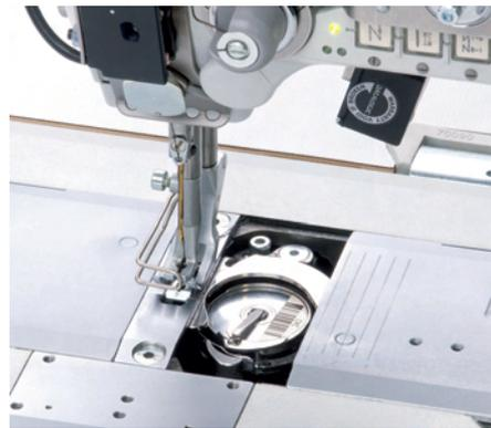
Elektronisch geregelte Fadenspannung (ETT mit Fadenkraftsensor) für programmierbare Oberfadenspannungen; Unterfadenidentifikation durch Erfassung des jeweiligen Barcodes.
