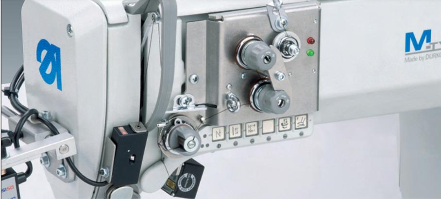
Mechanisch justierbare Fadenspannung (MTT mit Fadenkraftsensor und fixierbarem Stellelement)
