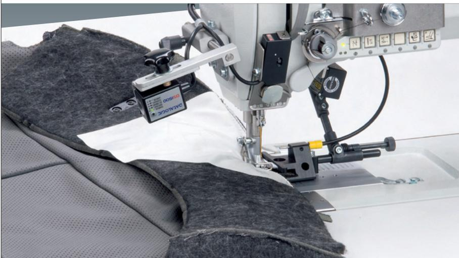
Sichere Erfassung des Sollreißnahtbereiches durch Glasfaseroptik
