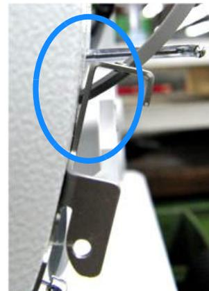
Position zu weit vom Nähmaschinenarm entfernt
