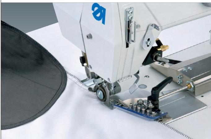
Der Kantenführungsapparat erleichtert das Positionieren und Führen des Nähgutes.
