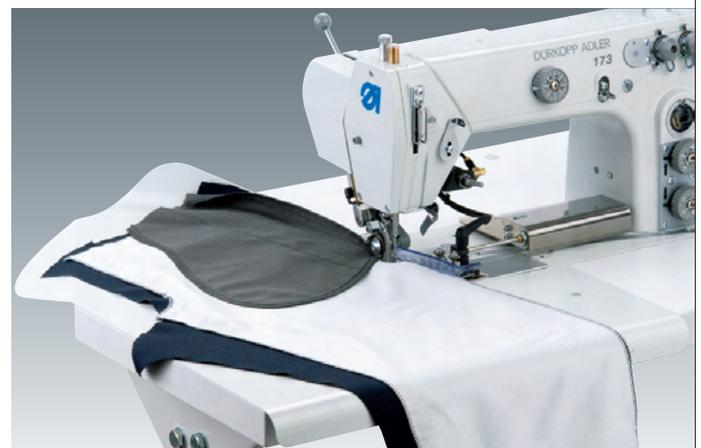
Zum Schließen der Seitennähte wird der Kantenführungsapparat im Bereich des Taschenbeutels ausgeschwenkt.
