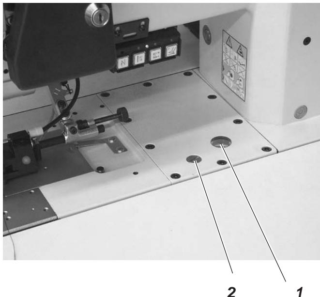
Použijte k naplnění olejové nádržky výlučně mazací olej **DA-10** nebo stejně hodnotný olej s následující specifikací:
