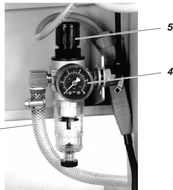
Pneumatický systém šicího pracoviště a dodatečných zařízení musí být napájen bezvodým stlačeným vzduchem.
