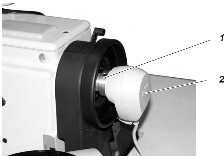
Šicí stroj nutno nastavit do potřebné polohy, když je nitová páka v horní úvrati.
