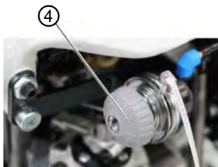
Rys. 25: Regulacja wstępnego naprężacza nici/naprężacza taśmy (3)
