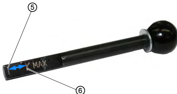
Obr. 82: Kontrola mazání chapače (3)
