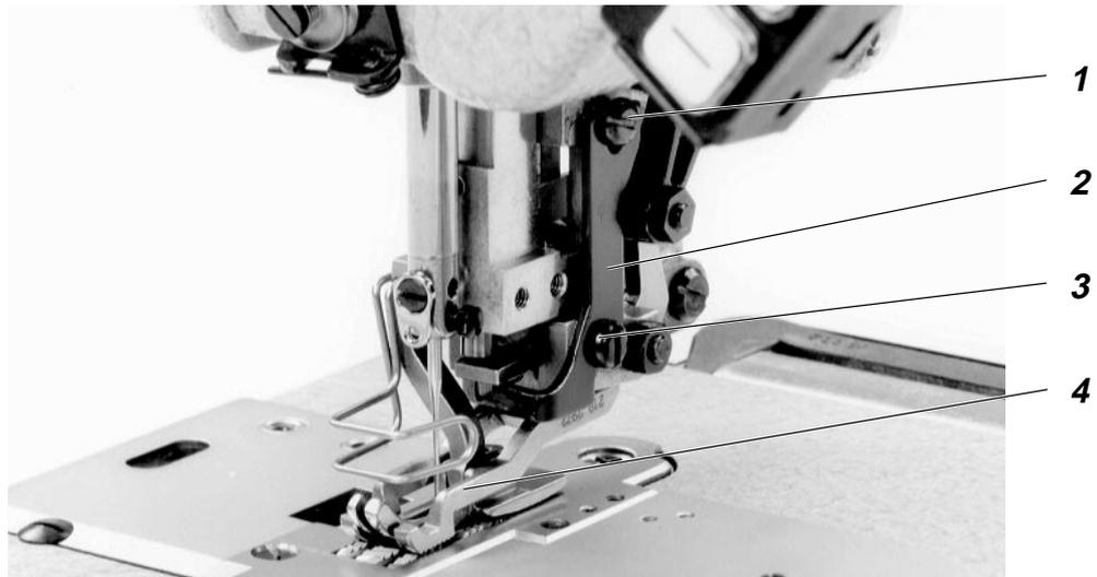
La escuadra de retención 2 limita la posición inferior del movimiento del pie transportador cuando se efectúa el levantamiento del prensatelas. Levanta el pie transportador 4 al efectuar el levantamiento.
