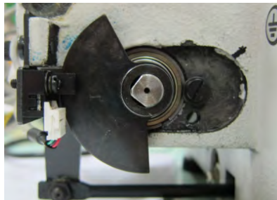
Fig. 28: Disque de capteur du dispositif coupe-fil
