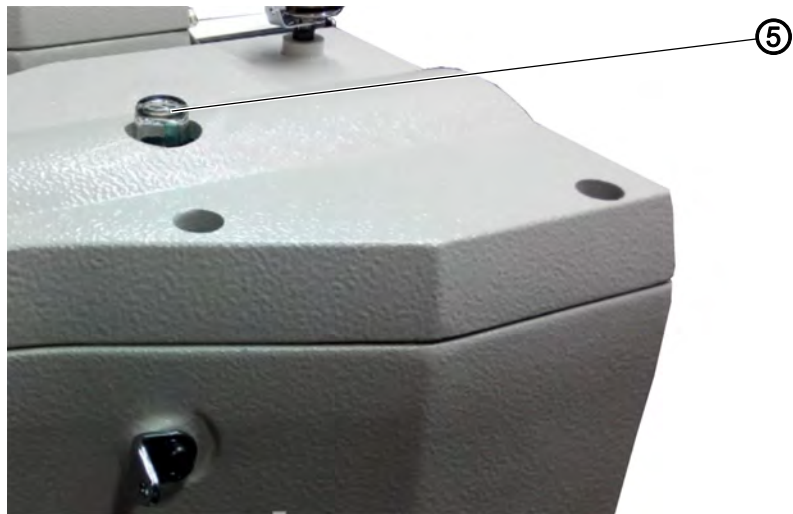
Fig. 33: Contrôler le niveau d'huile de l'entraînement (2)
