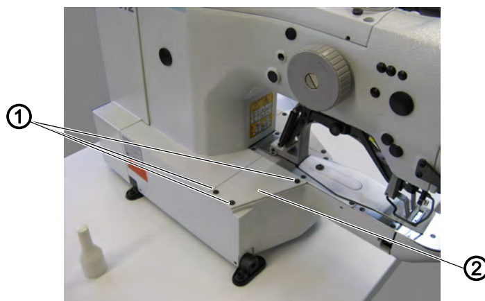
Fig. 5: Enlever et remettre la protection latérale à gauche
