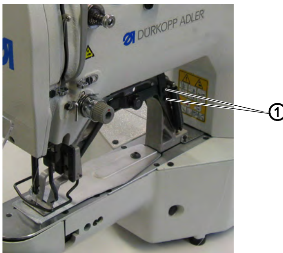
Fig. 22: Régler les pieds-presseurs
