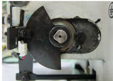
5. Prüfen, ob die Bohrung des Fadenziehmesser und die Nadelführung der Stichplatte übereinander liegen:
