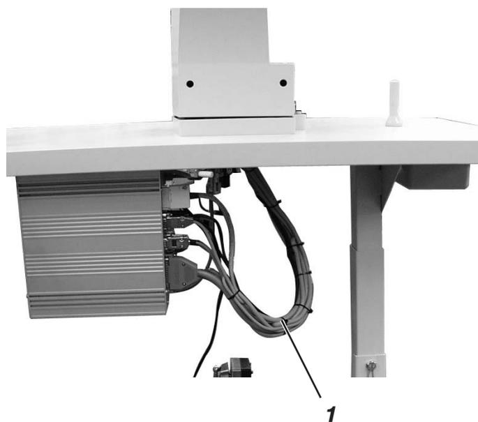
Um das Zurückklappen des Maschinenoberteils zu ermöglichen, müssen die Leitungen, welche aus dem Oberteil durch den Durchbruch in der Tischplatte entweder zur 15-fach Steckerleiste am Schaltkasten oder zum Kabelkanal führen, genügend lang sein. Hierzu müssen die Leitungen mit Hilfe der Kabelbinder in einem großen Bogen 1 verlegt werden.
