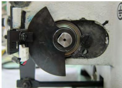
5. Vérifier si le trou du couteau tire-fil et le guide-aiguille de la plaque à aiguille sont superposés :
