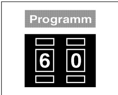
Programm P60 prüft, ob die 24V-Spannungsversorgung bei abgeschalteten Ausgangstreibern Strom liefert.
