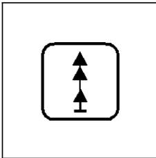
Bei eingeschaltetem Softstart werden die ersten Stiche am Nahtbeginn mit reduzierter Drehzahl genäht.
