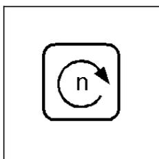
Mit Hilfe dieser Taste kann die Oberteildrehzahl eingestellt werden. Die einstellbaren Drehzahlen können der untenstehenden Tabelle entnommen werden.
