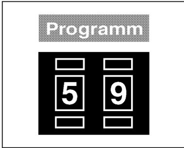
Programm P59 prüft den Arbeitsspeicher (RAM) und alle Timerschaltungen der Steuerung.
