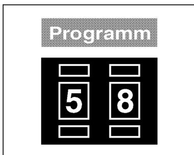
Programm P58 prüft den SIO-Baustein der Steuerung.
