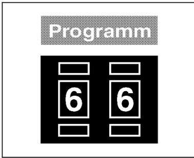
Programm P66 dient zum Testen von verschiedenen Drehzahlen des Nähtriebes.
