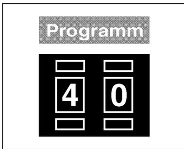
In Programm P40 wird die Anzahl von Teilen, die pro Spule genäht werden kann, eingestellt.
