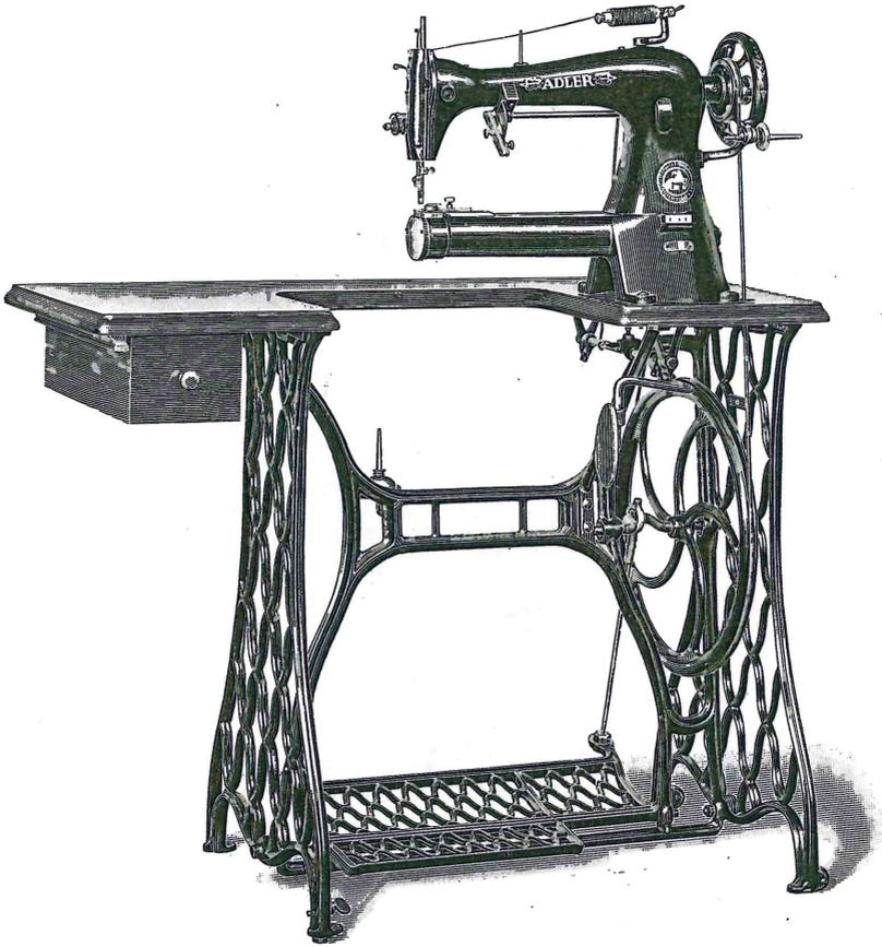
**Machine à coudre oscillante tube cylindrique**
