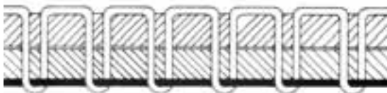
Fig. B: Tensione per il filo dell'ago troppo debole oppure tensione per il filo del crochet regolata troppo forte
