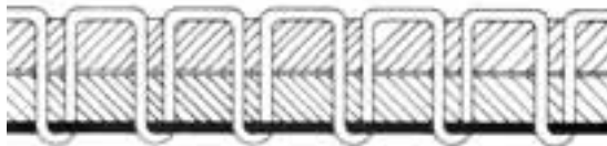
Fig. B: Tension du fil d'aiguille trop faible ou Tension du fil de crochet trop forte
