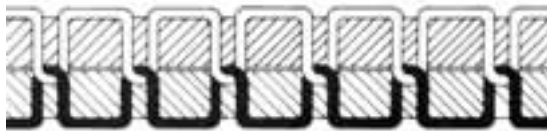
Fig. A: Entrelacement correct des fils au milieu de l'ouvrage
