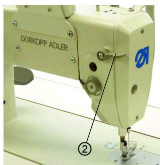
(2) - Hebel oben: Nähfuß in Hochstellung arretiert
