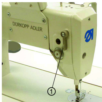
(1) - Hebel unten: Nähfuß unten
