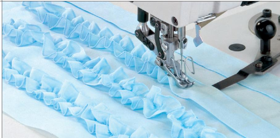
**275-140342-01 E3 / 275-142342-01 E3 – Kräuselarbeiten in Hemden und Blusen** mit Zwischenblech auf Schwingschiene (N900 003601) montiert, zum besonders intensiven Einarbeiten von Mehrweite.
