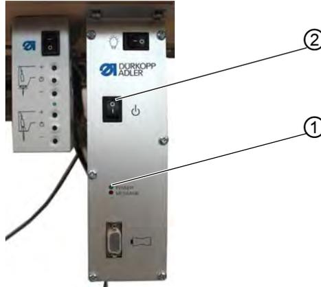
(1) - POWER-LED an der Steuerung (2) - Hauptschalter Stromzufuhr
