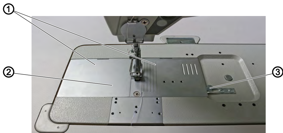
图 8: 打开和关闭针板滑动器
