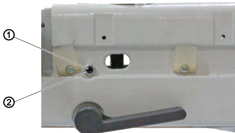
图 50: 设置抬压脚高度
