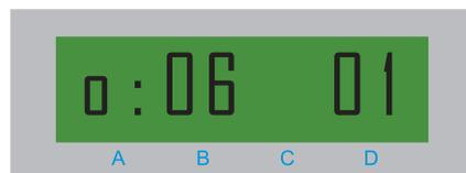
Mit Parameter *01* stellen Sie den Reset-Wert für den Spulen-Stichzähler A ein.
