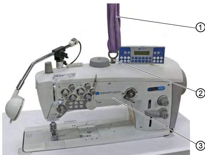
Afb. 40: Bovenste deel van de machine plaatsen (1)
