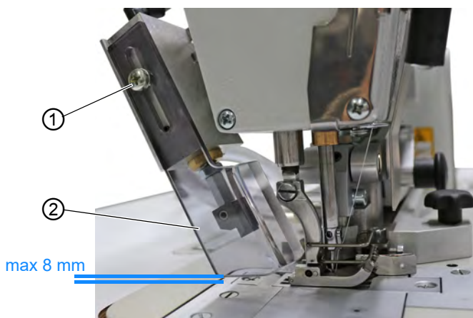
Fig. 27: Regolazione dell'altezza della protezione del separatore di catena
