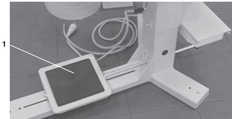
Mit dem Fußschalter wird der Programmablauf ausgelöst. Dabei wird zwischen zwei Schaltmöglichkeiten unterschieden:
