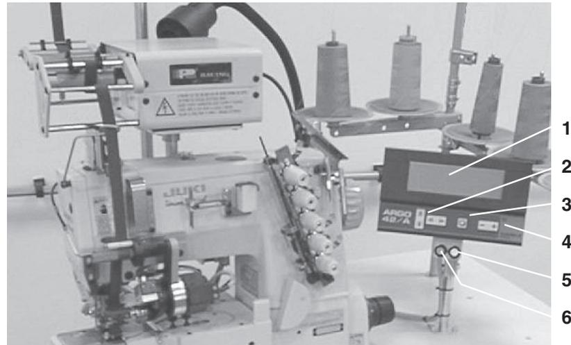
Mit dem Bedienpult wird der Automat während der Produktion bedient, es können bestehende Programme aufgerufen und neue programmiert werden.
