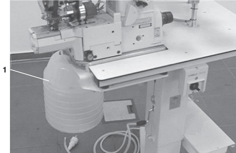
Im Auffangbehälter wird das von der Auszackvorrichtung ausgezackte Stoffband aufgefangen, das im Nähbereich abgesaugt worden ist.
