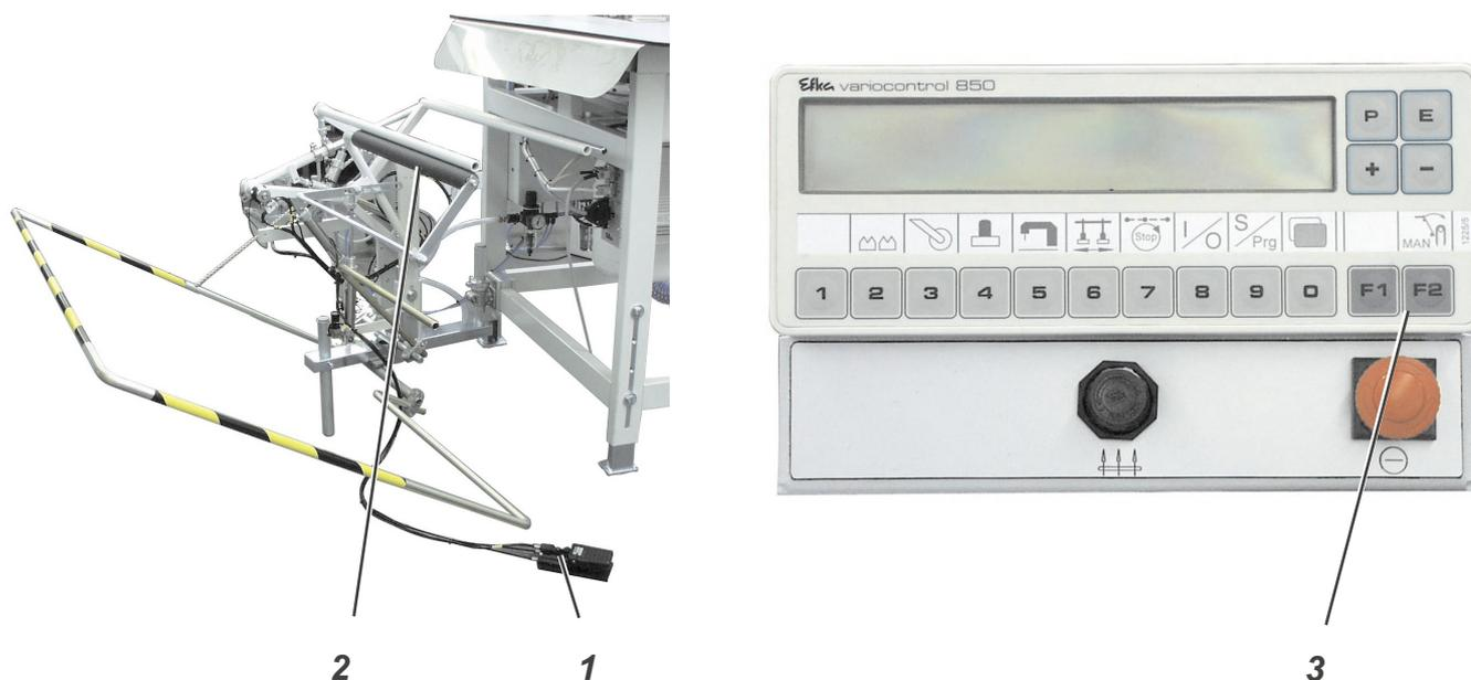
Auf dem Überwurfstapler 2 werden die fertig genähten Nähteile abgestapelt.
