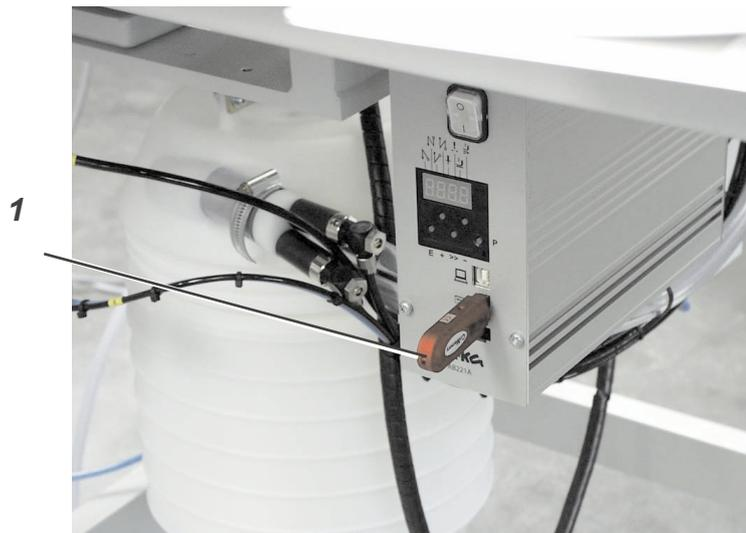
Der USB-Stick 1 dient zum Aufbewahren und zum Übertragen der Nähanlagensoftware.
