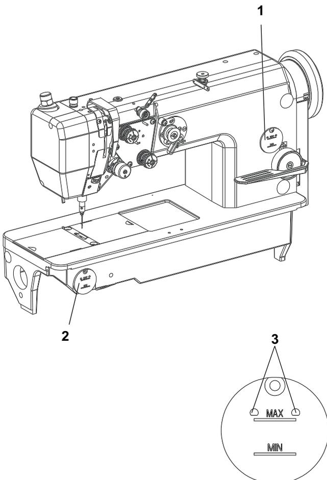
Für das Schmieren ist das Öl Esso SP-NK 10, DA 10 oder dergleichen in derselben Qualität zu verwenden (Viskosität bei 40° C: 10 mm²/s; Flammpunkt: 150°C). Der Ölbehälter (1) der Zentralölverteilung und der Ölbehälter (2) zur Greiferschmierung sind durch die Öffnungen (3) bis zur Marke max. zu füllen.
