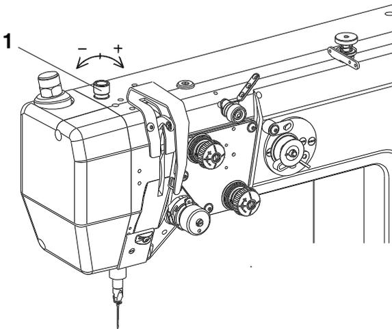
Der Anpreßdruck des Rollfußes soll am kleinsten aber genug sein, damit sich der Rollfuß beim Austreten der Nadel aus dem Material nicht aufhebt und damit die Transportkraft den Fadenzug beim Sticheinziehen überwindet.
