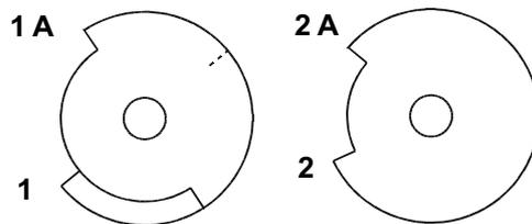
Die Positionen werden mittels Scheiben mit Ausschnitten gerade im Positionsgeber eingestellt.
