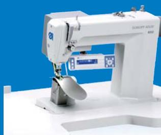
Ein ganz besonderes Highlight war die neue Ärmelinnähmaschine. Das Gehäuse ist komplett aus einem Guss. Zwei Transportbänder können über unterschiedlich programmierbare Drücke auf das Material das Nähen von Kurven deutlich leichter machen. Besonders bei DOB Ärmeln mit ihren engen Radien bringt dies deutliche Handlingvorteile.
