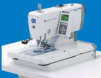
Basierend auf einer der meistverkauften Knopflochmaschine der Welt, wurde eine neue Maschine gezeigt, bei der auf eine Oberfaden Fadenklemme verzichtet werden konnte. Änderungen im Knopflochschneiden, eine höhere max. Drehzahl und eine neue Software in Verbindung mit der mechanischen Neukonfiguration erhöht die Leistung um bis zu 25-30%.
