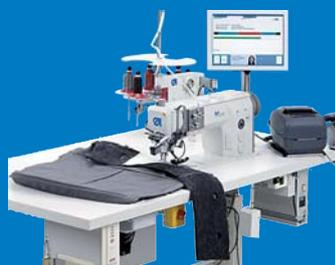
Elektronische Fadenspannung und Kurzfadensabschneider stehen ab sofort auch für Solltreißnähte zum Einsatz. Im Gegensatz zu einfachen Lösungen wird bei diesem High-Tech Aggregat während des Nähens laufend der Spannungsverlauf des Nähfadens kontrolliert. Verlässt dieser die vorgegebene Bandbreite, meldet die Software einen Fehler und protokolliert dies.
